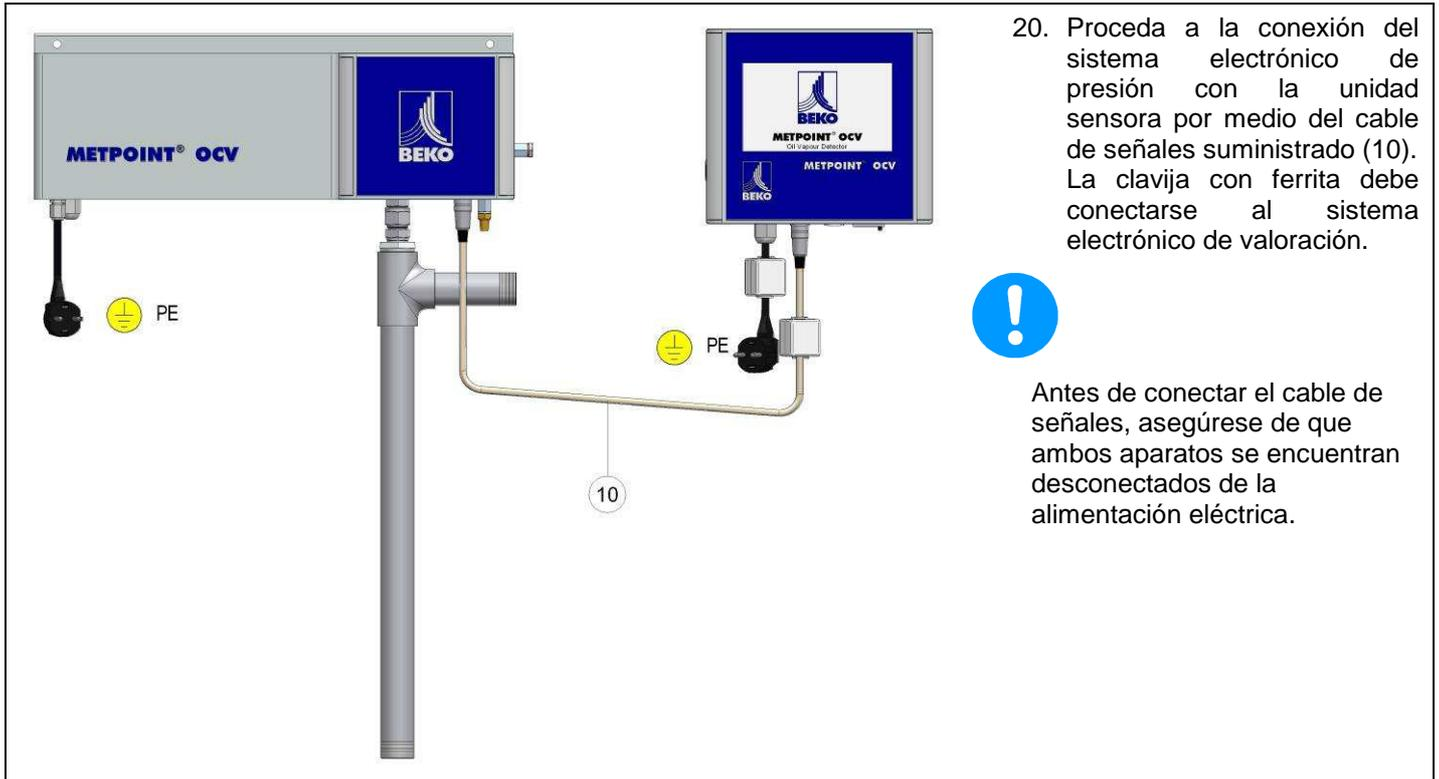
20. Proceda a la conexión del sistema electrónico de presión con la unidad sensora por medio del cable de señales suministrado (10). La clavija con ferrita debe conectarse al sistema electrónico de valoración.
