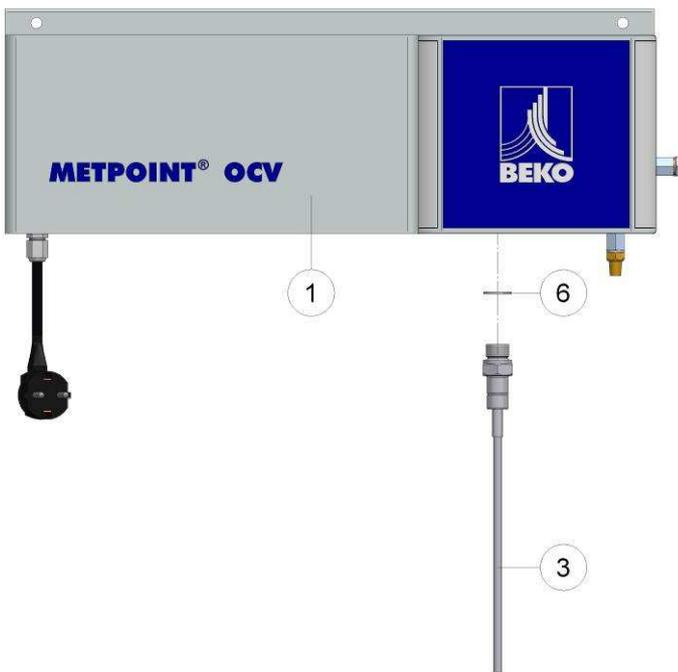
10. Conecte la sonda (3) a la unidad sensora (1). Tenga cuidado para que el segundo disco obturador (6) no se dañe en el proceso.
