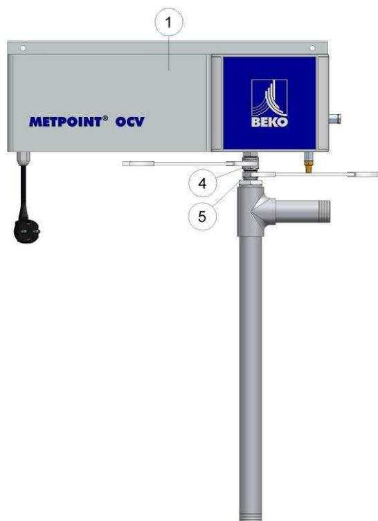
11. Visser avec précaution l'écrou d'accouplement (4) à la force des doigts sur le corps du raccord (5).
